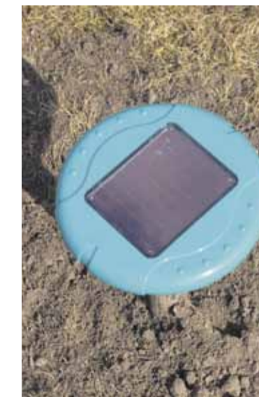
Urządzenie solarne do odstraszania kretów regularnie emituje ledwie słyszalne, krótkie i wysokie dźwięki
